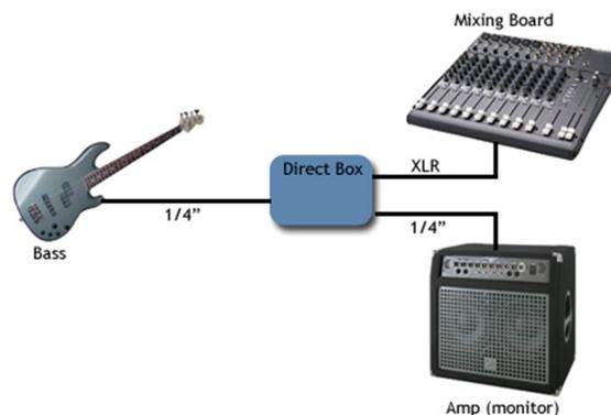
Versorgt wird die DI-Box über Phantompower und ein optionales Standby-Batteriesystem. Eine LED zeigt an, wenn die Batterieleistung niedrig ist.
